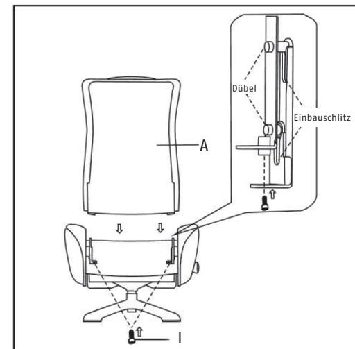
Schieben Sie die 2 Schrauben in die Nut und ziehen Sie die Schrauben von unten nach oben fest.
