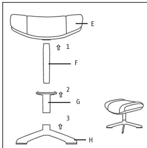
Setzen Sie die einzelnen Elemente nach dem Ablaufschema 1 bis 3 zusammen und drücken Sie die einzelnen Teile aufeinander.
